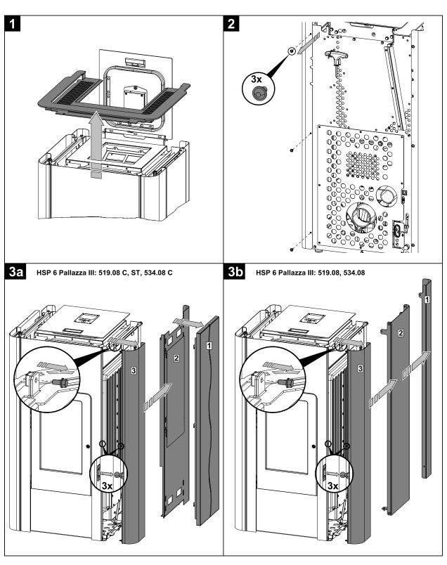
Abbildungen 2a: Demontage der Seitenwand
