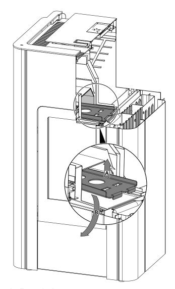
Abbildung 1: Demontage der Zugumlenkung
