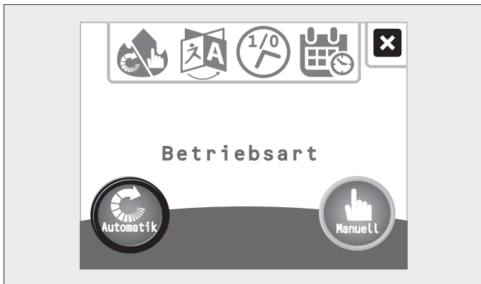
Abb. 3.22 Touch-Bedienfeld – Betriebsart Manuell
