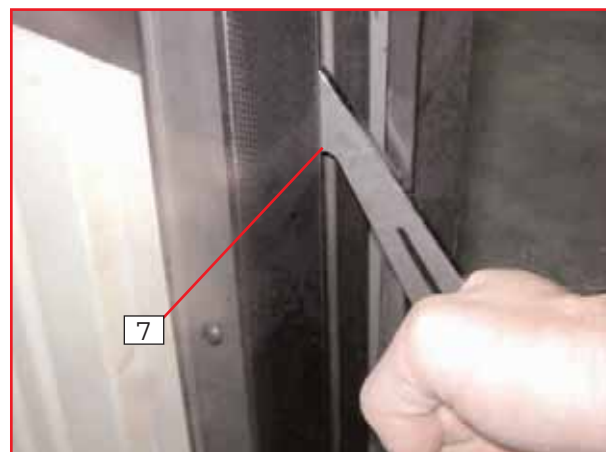
Figuur 4: vergrendeling gesloten deur (verankering 90° draaien)
