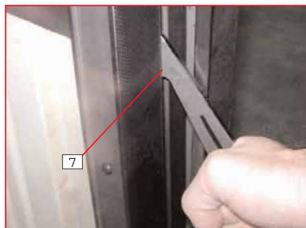
Figure 4 : blocage porte fermée (tourner la gâchette de 90°)
