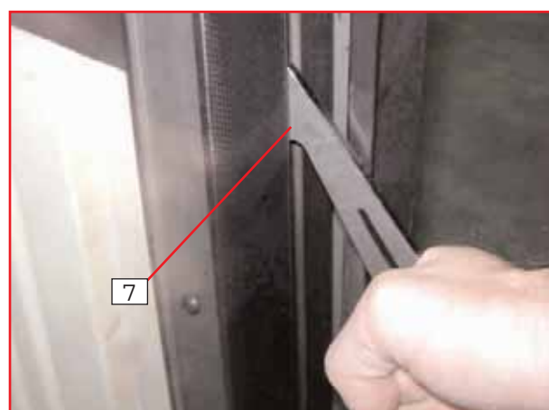
Figura 4 : bloqueo puerta cerrada (rotar el gatillo unos 90°)
