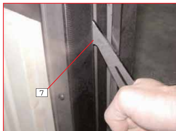
Abbildung 4 : Blockierung der geschlossenen Tür (die Klinke um 90° drehen)
