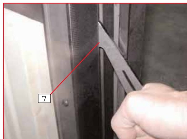
Εικόνα 4 : εμπλοκή κλειστής πόρτας (στρέψτε τον εμπλοκέα 90°)
