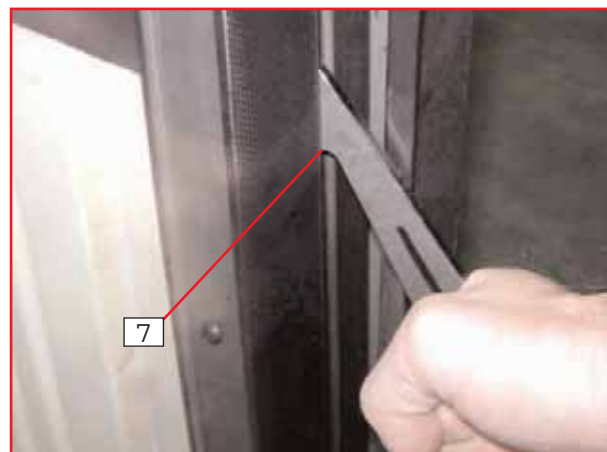
Figura 4 : bloccaggio portellone chiuso (ruotare il nottolino di 90°)
