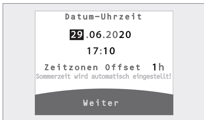
Abb. 3.27 Touch-Bedienfeld – Einstellen Datum und Uhrzeit
