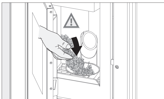
Abb. 2.19 Pellets bei leerem Pelletschacht mit der Hand einfüllen
