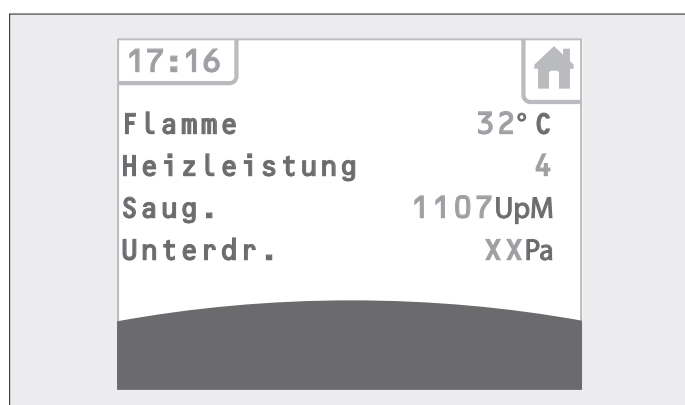
Abb. 3.31 Touch-Bedienfeld – Anzeige „Aktuelle Informationen“
