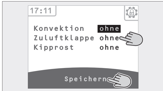
2.15 Verbrennungsluftklappe („Zuluftklappe“) aktivieren und bestätigen
