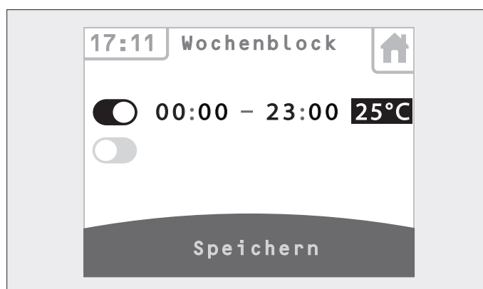
Abb. 3.26 Touch-Bedienfeld – Schaltzeiten einstellen
