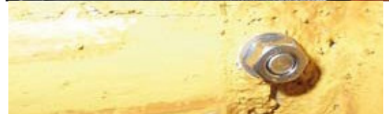
17. Verschlusschraube für das Gestänge links entfernen
