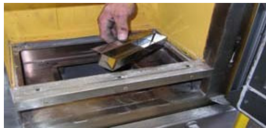
8. Verschlusschale des Rauchgasweges um 180° drehen und in die linke Halterung positionieren.
