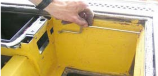
12. Das Gestänge der Anheizklappe nach vorne herausziehen
