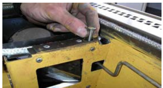
10. Scharnierstift der Anheizklappe heraus-ziehen.
