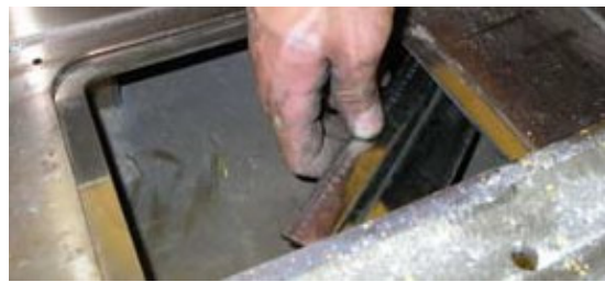
7. Verschlusschale des Rauchgasweges aus seiner rechten Halterung herausziehen.
