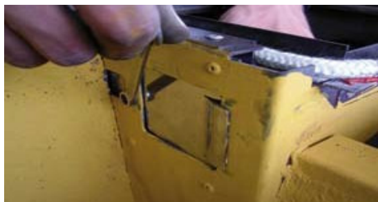
14. Mit einem 8mm-Gabelschlüssel und Steckschlüssel das Verschlussblech der linken Öffnung entfernen.
