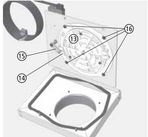
Abb. 3.16 Montieren der Luftventileinheit im Deckel der VSR-Box
