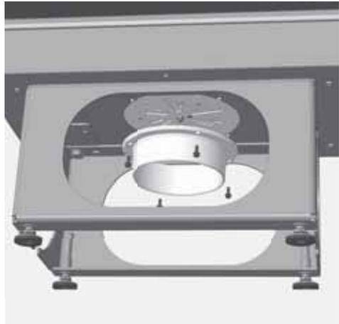
Abb. 2.5 Montage des Verbrennungsluftstutzens von unten am Bodenluftventil
