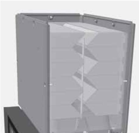
Abb. 2.45 Lage der Speicherplatten und Gewindestangen
